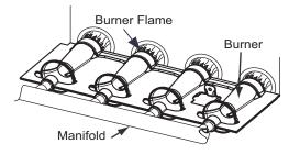
Fig. 65 – Burner Flame
