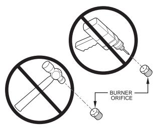
Fig. 62 – Orifice Hole
