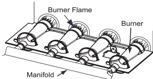
**Fig. 65 – Burner Flame**
